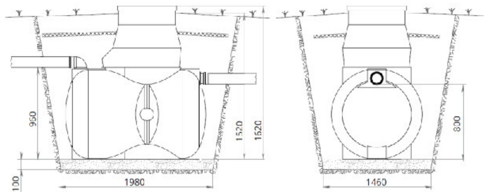
**Рис. №2 Монтажная схема Дочиста Профи 6**
