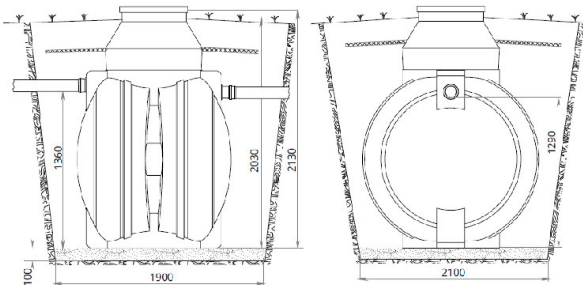
**Рис. №3 Монтажная схема Дочиста Профи 10**
