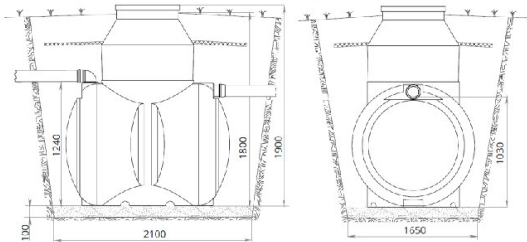
**Рис. №3 Монтажная схема Дочиста Профи 8**
